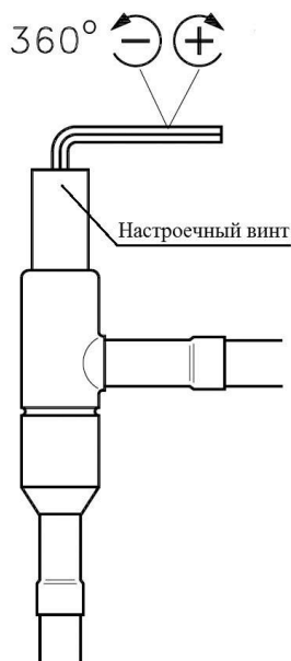
Рис. 3.4 Настройка регулятора давления конденсации
